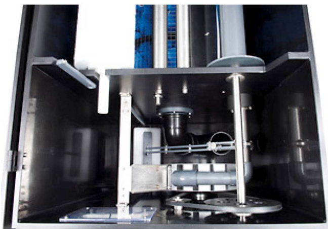
Abbildung 2: Blick von oben auf Wasserrad mit Schwimmerregelung
